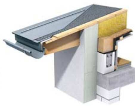
Bild 2: Oventilerad takkonstruktion med helisolerade sparrar
