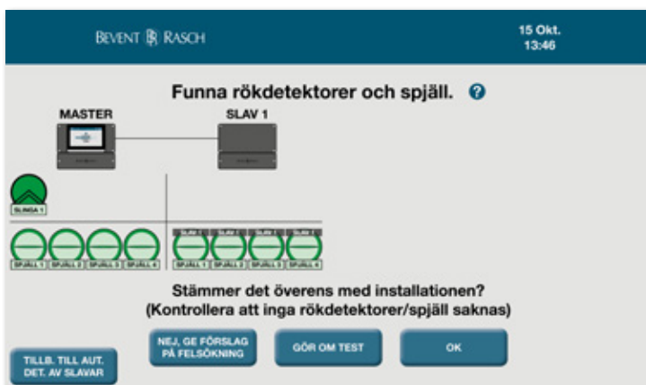
Exempelsystem med 1 st rökdetektorslinga och 8 st brandspjäll.
